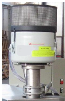
Condenseur de vapeurs
